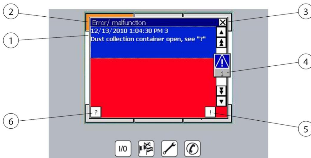
Rys. 40: Komunikat o usterce zbiorczonego pojemnika na pył
